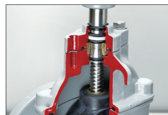
スラストカラーと弁棒に設けた勾配がスラスト荷重を分散して受けることで弁破損を防止します。
