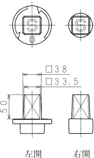
(2) エクセルプロの止水は、ゴムを圧縮して行いますので、全閉時の操作力の変化は緩慢です。
