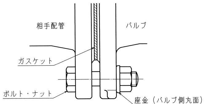
d ボルト、ナットの締め付け順序と締め付けトルク
