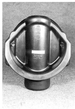
耐久試験後の弁体(呼び径150)異常なし
