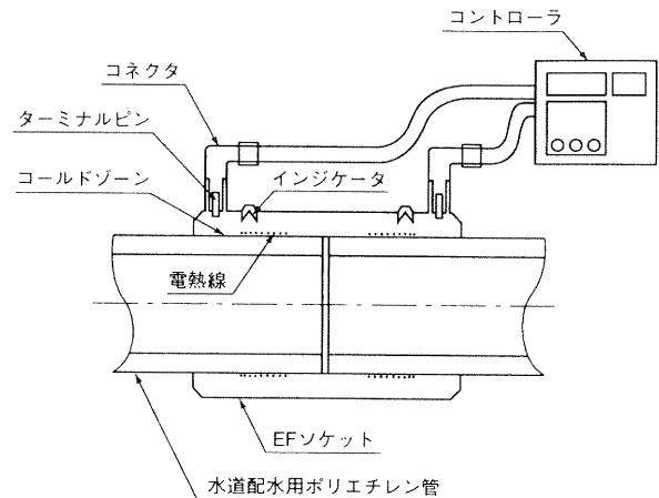
図2 EF接合の構造
