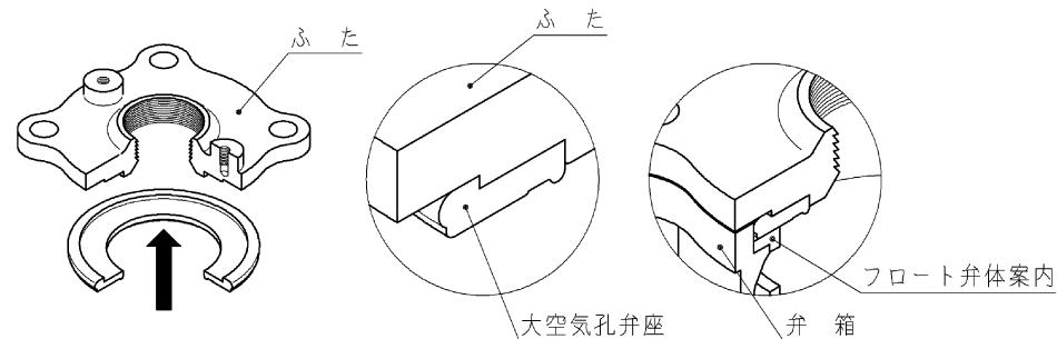
注) まず板状の大空気孔弁座の向きに注意し、ふたの段落部に預け、その後弁箱の段落部へ収める感じで取付けてください。
