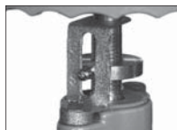
露出配管開度計部
