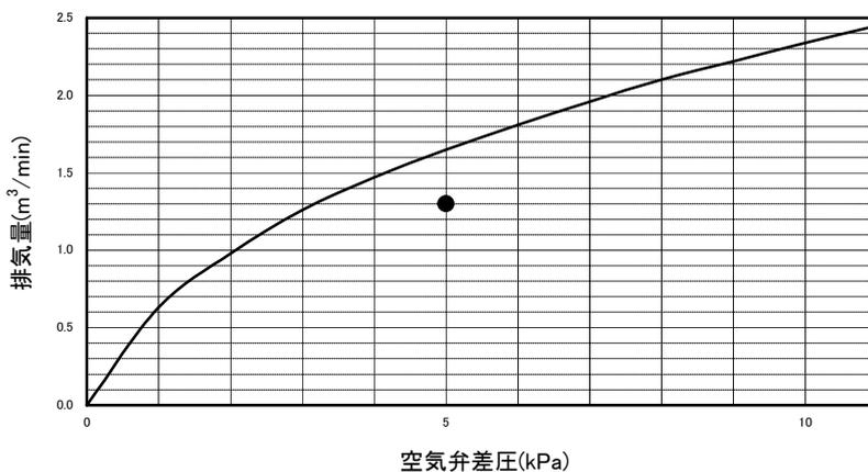
注) グラフ中の●は呼び径 25 の規格値 1.3m<sup>3</sup>/min(5kPa 時の排気量の最小値)を示します。
