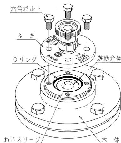
て残留圧力が抜けたことを確認した後、六角ボルトを抜き取ってふたをはずしてください。はずしたふたには、配管接続用のねじ部や内側には大空気孔弁座が付いていますので、傷を付れたり異物を付着させたりしないように取り扱いに注意してください。
