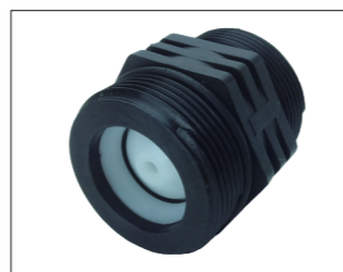
ウォーターハンマー防止オプション(R2のみ)：排気時のみ排気量を抑制し、水撃を防止します。
