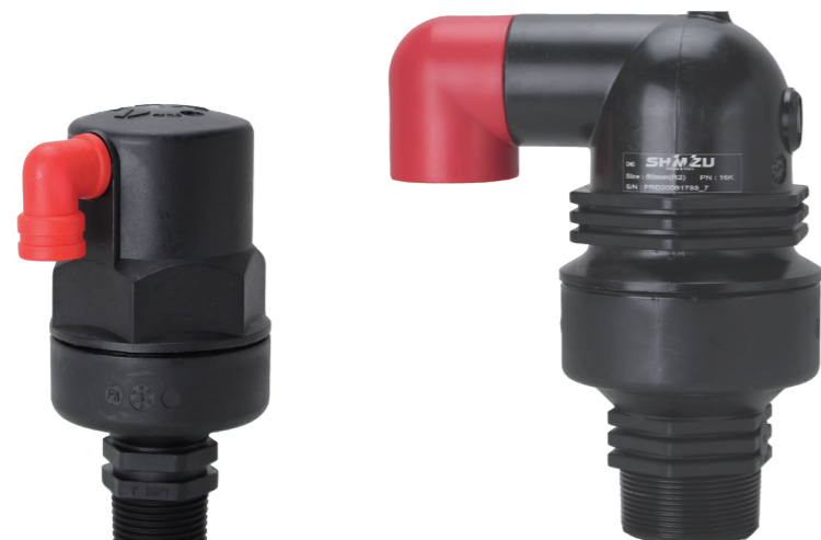
ウォーターハンマー防止オプション(R2のみ)：排気時のみ排気量を抑制し、水撃を防止します。
