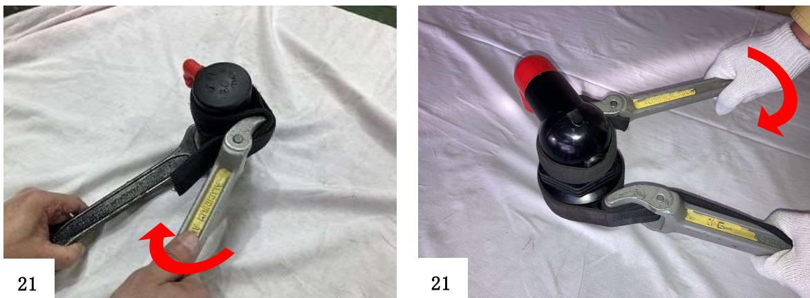
h エアスポット D40 形の下の補修用バルブを開きます。
