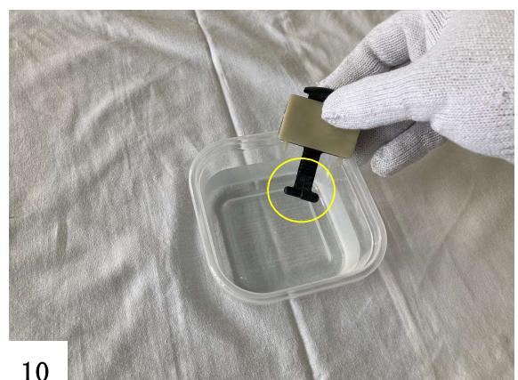
d ローリングシールのゴムの細い方をフロート弁体の太い溝の方から、挿し込みます。
