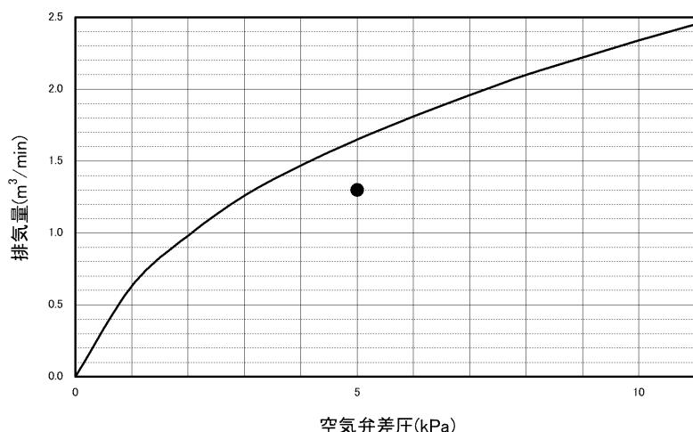
注) グラフ中の●は呼び径 25 の規格値  $1.3\text{m}^3/\text{min}$ (5kPa 時の排気量の最小値)を示します。
