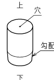
注 2) 本体にフロート弁体（穴を上側に）を入れて、ガスケットを預けエルボの上部へ置くと組み立てやすいです。
