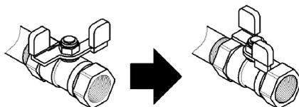
c スパナ（呼び24mm）などを使って六角ナットをゆるめ、カバーをはずしてください。
