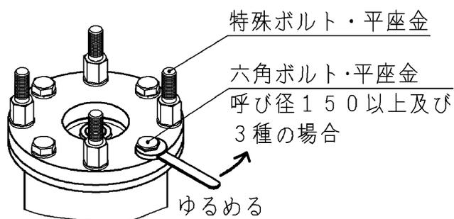
ボルトを全て抜き取ってふたをはずしてください。板状の大空気孔弁座を取り外します。
