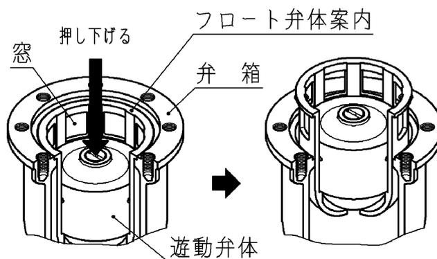
フロート弁体案内には遊動弁体一式（小空気孔弁座・小空気孔弁座押え含む）とフロート弁体が収まっていますので取り出してください。
