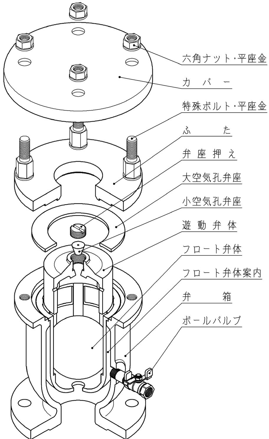
注) 本構造図は、呼び径75, 2種仕様を示します。
