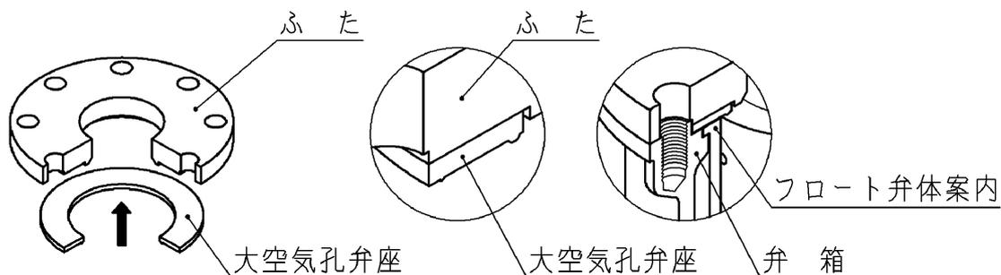
注) まず板状の大空気孔弁座の向きに注意し、ふたの段落部に預け、その後弁箱の段落部へ収める感じで取付けてください。
