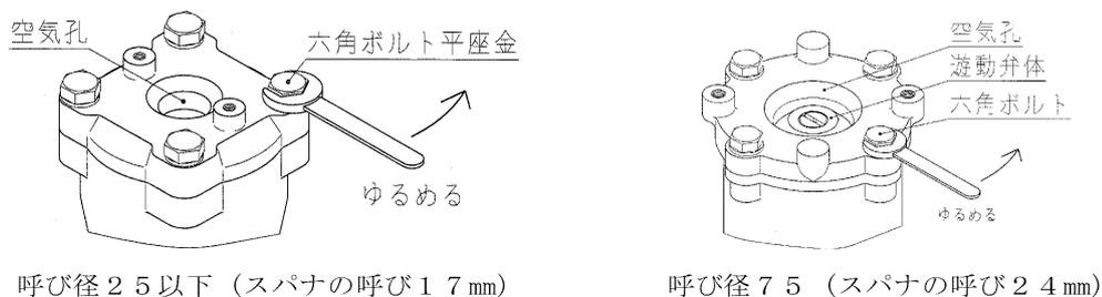
空気孔から指などで遊動弁体を押し下げてみて残留圧力が抜けたことを確認した後、六角ボルトを抜き取ってふたをはずしてください。
