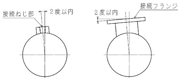
(2) 配管用の継手材の確認
