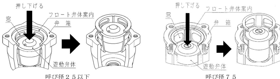
フロート弁体案内には遊動弁体一式（小空気孔弁座・小空気孔弁座押え含む）とフロート弁体が収まっていますので取り出してください。
