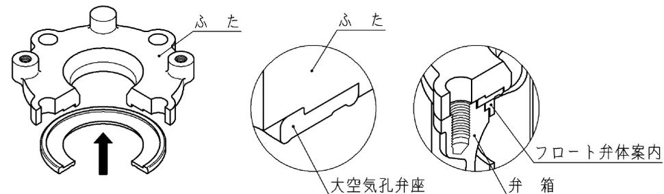
注) まず板状の大空気孔弁座の向きに注意し、ふたの段落部に預け、その後弁箱の段落部へ収める感じで取付けてください。
