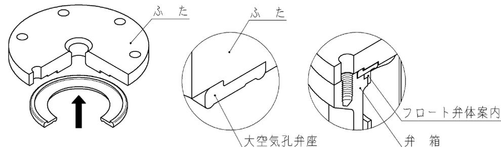
注) まず板状の大空気孔弁座の向きに注意し、ふたの段落部に預け、その後弁箱の段落部へ収める感じで取付けてください。
